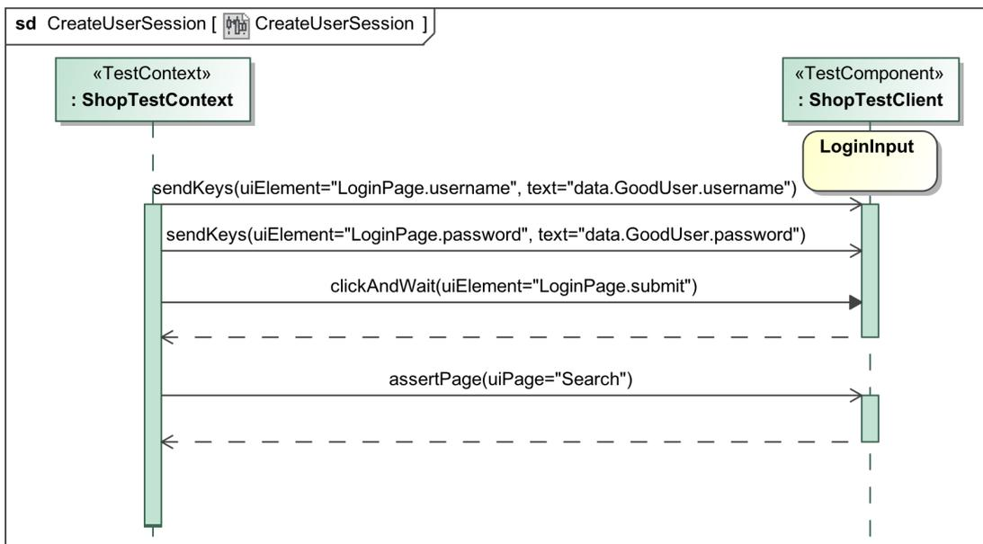
**Abbildung 6.9:** Wiederverwendbares Fragment für die Anmeldung am System mit einer gültigen Benutzerkennung
